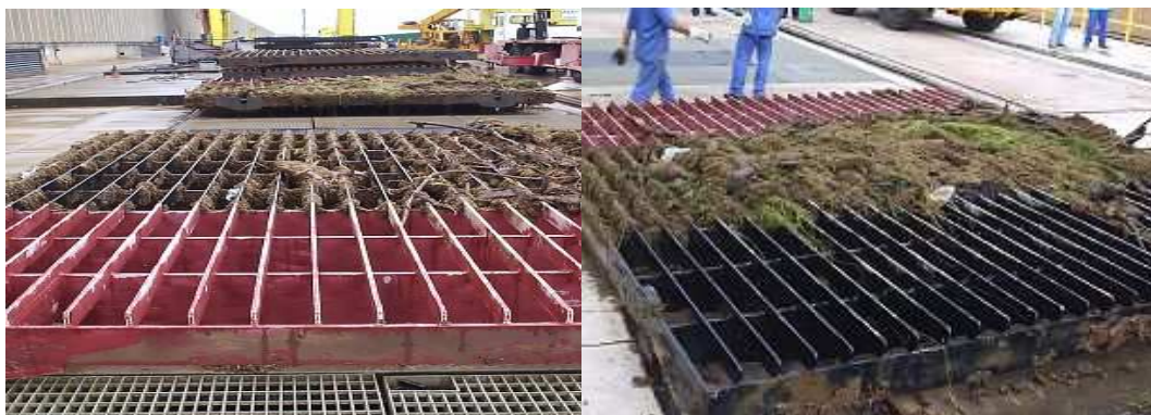
Fig. 6 – Grades revestidas com antiincrustantes e retiradas para inspeção após 02 anos de testes
