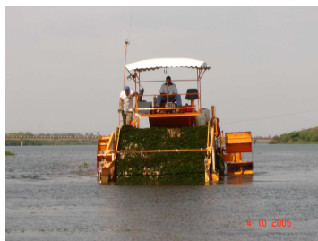
Fig. 5. Colhedora de plantas aquáticas Aquamarine em operação no reservatório de Jupuíá.
