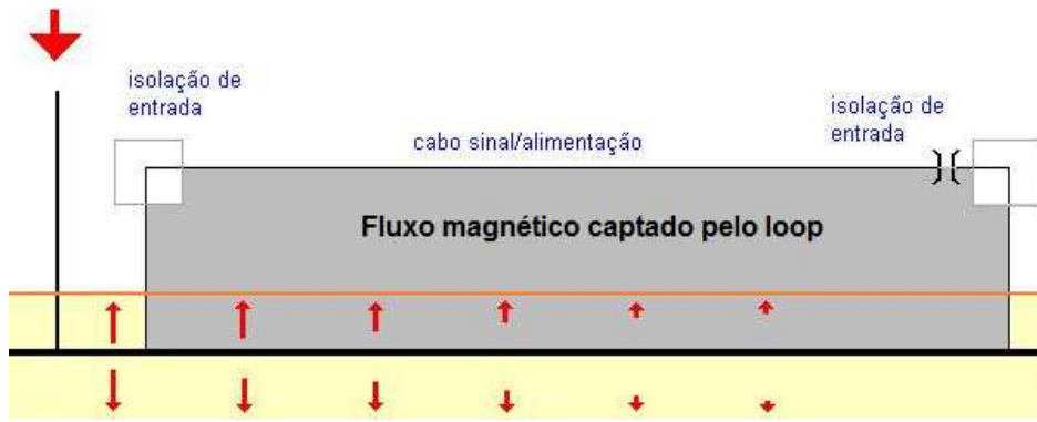
Fig. 3 – Representação do acoplamento magnético da perturbação em modo comum
