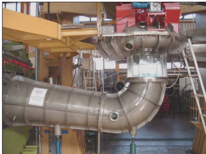
Fig. 2. Modelo Bakun montado en el Banco Universal de Ensayos de alta caída
