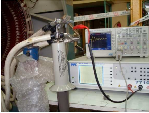
Fig. 5 - Ensayo "surge" a motor sincrónico 5.500 HP, registro.
