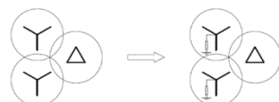
Figura 8: Configuración de conexionado actual vs configuración de conexionado propuesto con Reactores Limitadores de Neutro (centro estrella).
