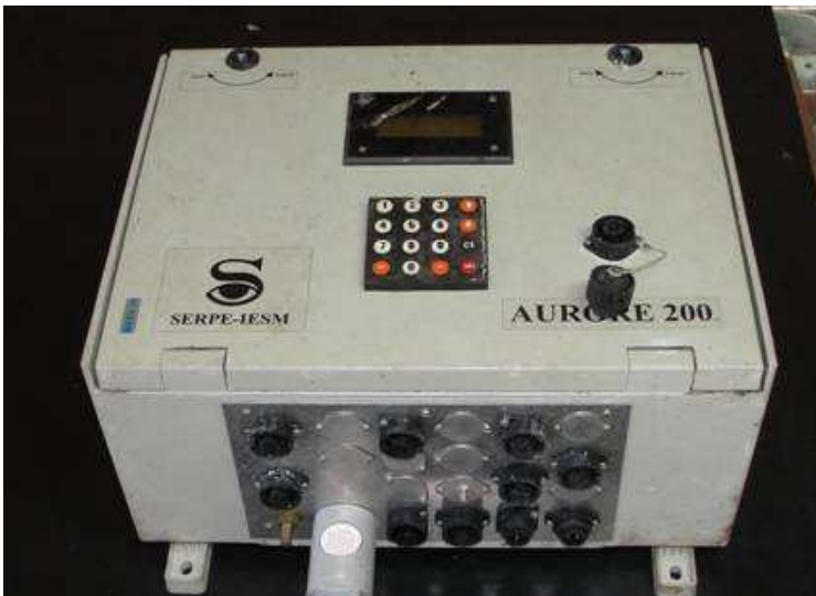
Figura Nro. 2 Data logger AURORE 200
