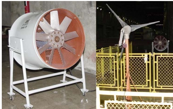
Figura 4: Sistema com ventilador e gerador eólico montado para testes.
