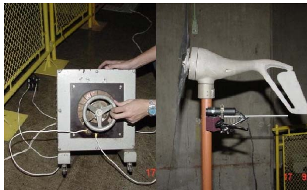
Figura 5: Carga utilizada nos testes e aerogerador com sensor de rotação instalado.
