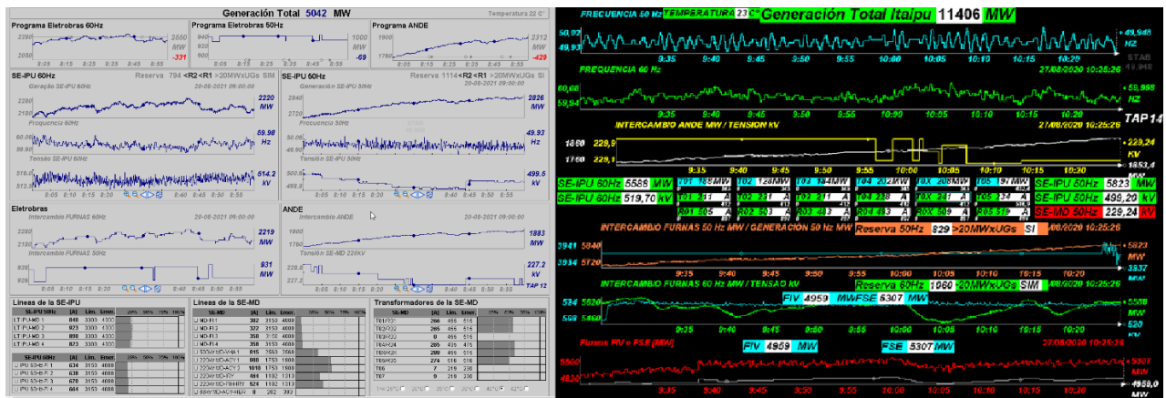
Figura 2: Exemplo de uma tela de alto desempenho (à esquerda) e uma tela com as mesmas informações, mas de má qualidade (à direita) aplicadas ao videowall do DC-IPU.
