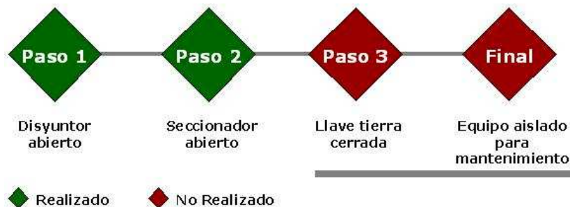
Figura 6 - Lógica de funcionamiento del Sistema SAMOP
