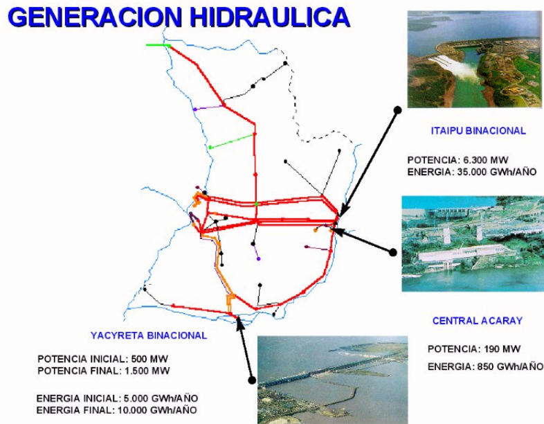
Figura 3: Generación Hidráulica del SINP
