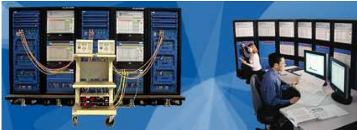
Figura 7 – Ensayo en malla cerrada utilizando RTDS
