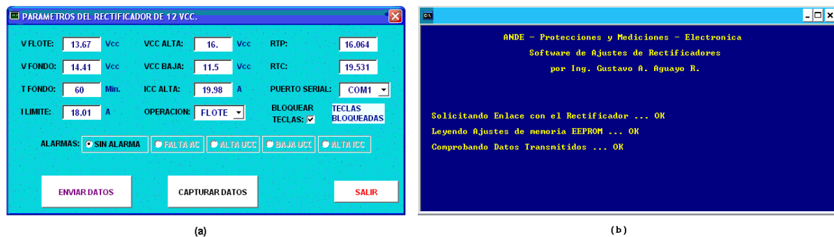
Figura 4: (a) Interfase Hombre-Máquina, en FoxPro; (b) Interfase Máquina-Máquina, en C
