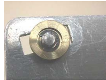
Fig. 15 Conjunto pasador-anillo de retención-arandela con rebaje colocados en el interruptor
