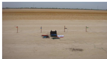
Figura 4: Medición según método de Wenner en el terreno
