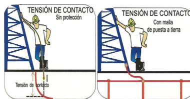
Figura 2: Tensiones de contacto
