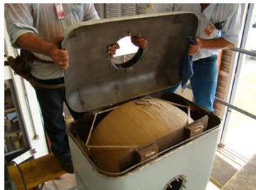
**Figura 11: Tanque destapado con herramienta de corte**
