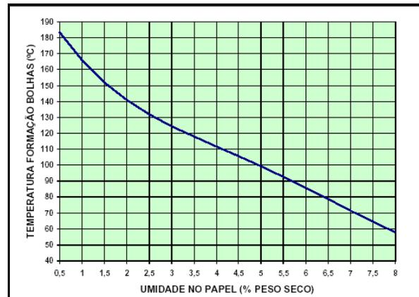
Figura 4 – Humedad x Temperatura de formación de burbujas en el aceite.
