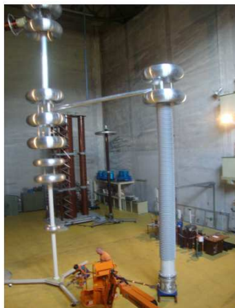
Figura 1: Aislador ensayado en el laboratorio del proveedor
