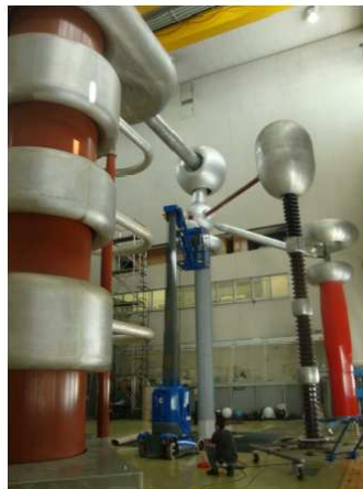
Figura 2: Aislador siendo ensayado en un laboratorio de Suiza
