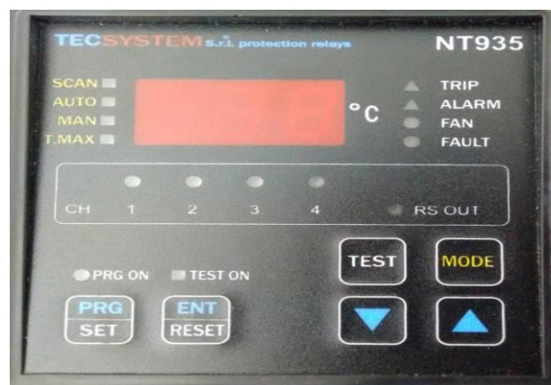
Figura 3. Central de medición de temperatura (NT935).
