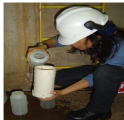
Fig. 22 – Colecta de agua para DBO
