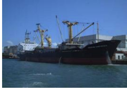
Fig. 03 – Descarga de Lastre
