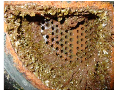
Fig. 07 – Incrustaciones en TC Turbina
