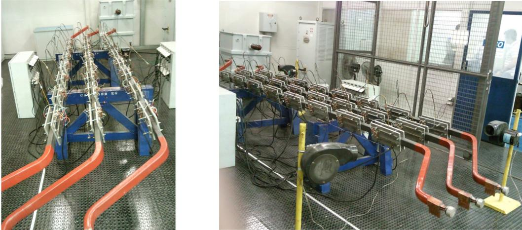
Figura 2 – Arranjo adotado para o ensaio de envelhecimento elétrico
