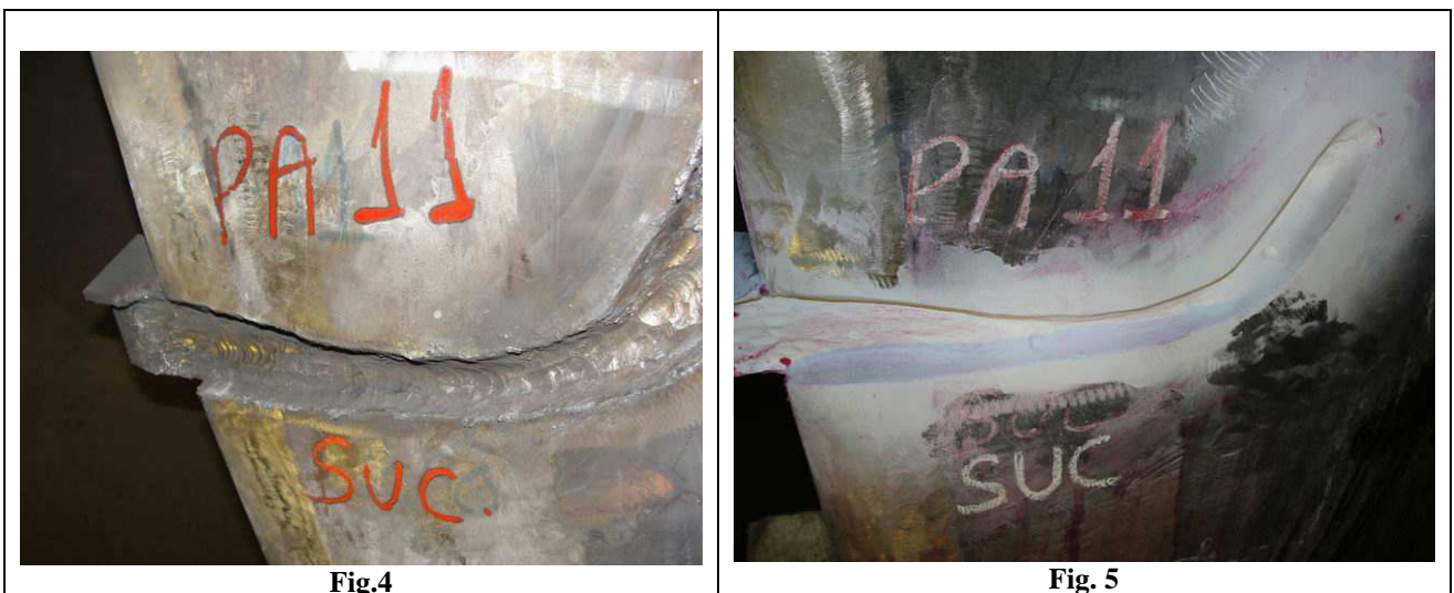
Fig.4– Limpieza de raíz lado succión - Fig.5 Ensayo de LP en la raíz lado succión
