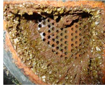
Fig. 07 – Incrustaciones en TC Turbina
