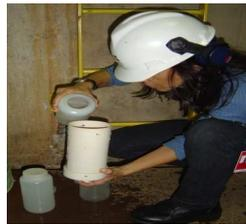
Fig. 22 – Colecta de agua para DBO
