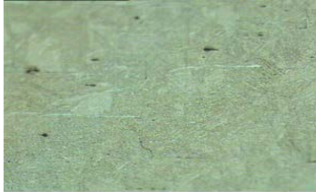
Figura 7 – Micrografia do aço Inox, ataque Villela, 100x.
