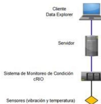
Cuando una alarma es configurada, descargada al sistema CompactRIO y sus condiciones son disparadas. De igual manera, una alarma puede ser disparada por pronósticos externos o software de reconocimiento de patrones que se ejecuta en la infraestructura del servidor.
