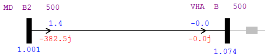
Figura 4 – Simulación de la operación en vacío de la LI 500kV MD-VHA 1
