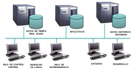
Figura 1: Configuración del SCADA-EMS de Itaipú
